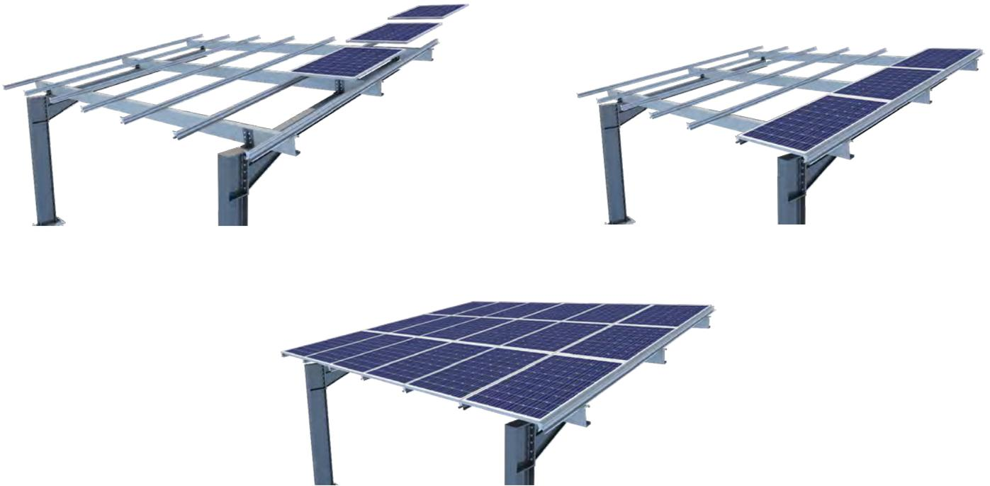
Installer les modules photovoltaïques du **bas vers le haut** et **colonnes par colonnes**.
