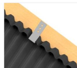
Retirez le film de protection du butyle et **maroufler** la bande afin d'épouser les tuiles. Maintenez la bande en place en partie haute à l'aide de crochets de solin.
