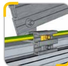
Une fois le câble mis en place, serrer la vis pointeau afin qu'elle perce la gaine du câble et que celle-ci entre en contact avec l'âme du câble.
