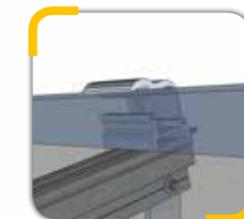
Ajuster la position des fixations extérieures hautes afin de les mettre en butée contre le cadre du module puis serrer les brides de fixation de celles-ci.
