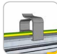
Le collier passe câble maintient le câble sur le rail et ainsi éviter que ceux-ci soient à même le complexe d'étanchéité.
