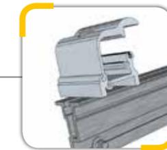
Afin de mettre en place les fixations extérieures sur le profilé d'inclinaison, faire glisser l'écrou carré de la fixation dans la rainure du profilé prévue à cet effet.
