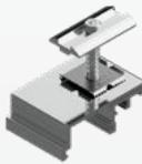
La deuxième rangée de modules se met en appui sur la base de la Fixation Universelle et contre le ressort (écart entre les modules 9 mm).
