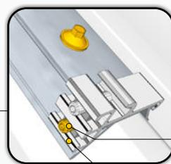
Serrage de la vis inox STHC (M6 x 20) à bout pointeau pour le maintien de la première rangée de Fixations Extérieures.
