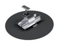
Serrer la vis de la Fixation Extérieure, vis inox six pans creux Ø 5 mm (ne pas utiliser de visseuse à percussion).
