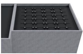
Clipper les Fixations Extérieures (extrémités du générateur) et les Fixations Universelles (centre du générateur) aux rails Roof-Solar EPDM.
