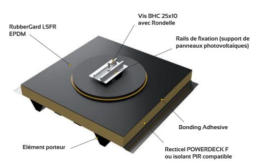
Pour chaque projet, un plan de calepinage est fourni avec la position des plots sur le toit. Fixation du rail au plot : fixer le rail pré-percé à l'axe au plot avec la rondelle M10x22 et la vis BHC M10x25 (Couple de serrage: 7 Nm). Clé six pans Ø 6 non fournie.
