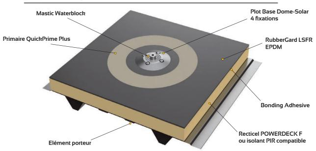
Du primaire QuickPrime Plus est appliqué sur la membrane EPDM, à raison de 30 gr/plot ou 0.04 l/plot environ à l'aide d'un tampon applicateur, sur un rayon de 20 cm à partir du point central ; uniformément réparti sur toute la
