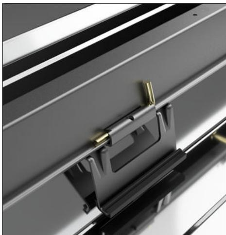
Glisser une clé de verrouillage sur le côté du rail pour chaque support de la colonne non concerné par les points fixes. Effectuer  $\frac{1}{3}$  de tour pour verrouiller la clé en position sur le cavalier support. L'ergot empêche la clé de sortir de son logement.
