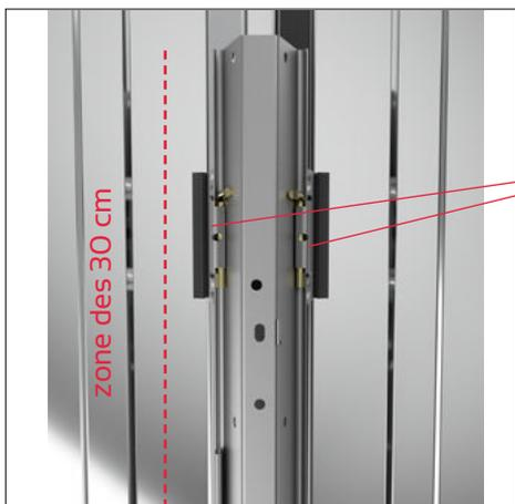
Haut de générateur dans la zone des 30 cm (partie éclissage du rail), 2 clés de verrouillage au cavalier support. Effectuer  $\frac{1}{3}$  de tour pour verrouiller la clé en position sur le cavalier support.
